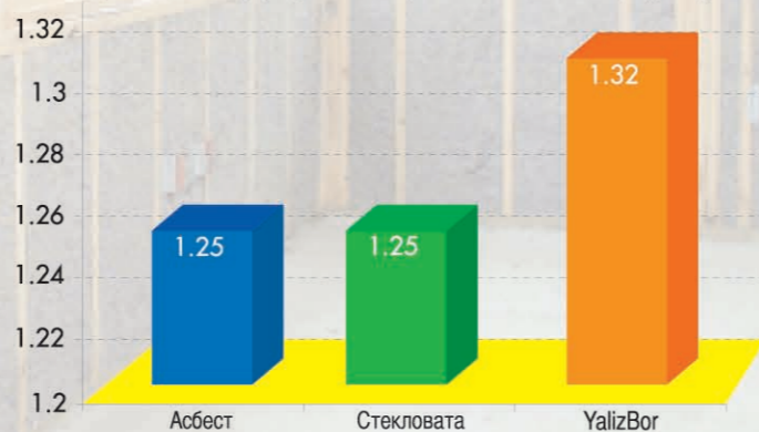
Теплопроницаемость минеральных волокон Сравнение коэффициентов сопротивления теплопередаче (50 мм)
